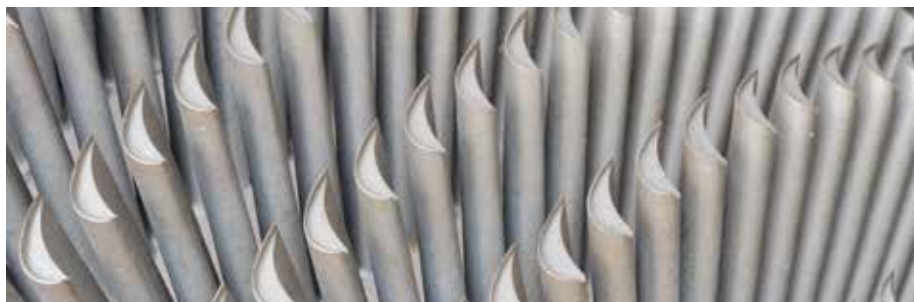
Bild 14: Läufer einer Dampfturbine
